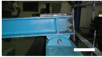
Resim 3.2. Sabit ve Kayıcı mesnet detayı
