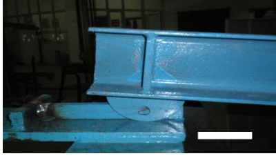
Resim 3.2. Sabit ve Kayıcı mesnet detayı
